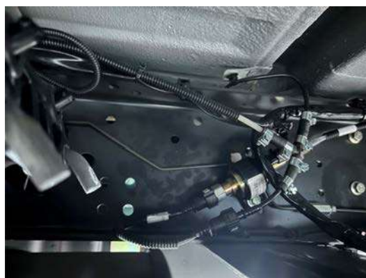
Рисунок 27 – Дозирующий насос топливной магистрали
