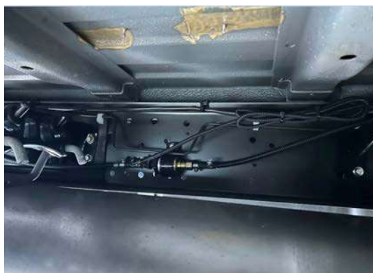
Рисунок 26 – Дозирующий насос топливной магистрали
