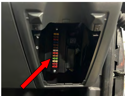
Рисунок 4. Блок предохранителей и реле в кабине водителя за ящиком для мелких вещей с правой стороны панели приборов
