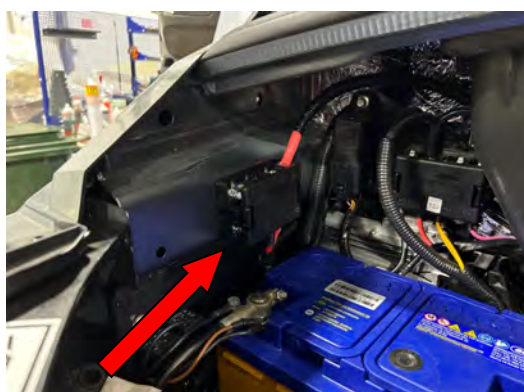
Рисунок 5. Блок предохранителей под капотом справа вблизи штатной аккумуляторной батареи (АКБ) автомобиля
