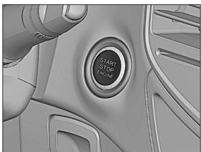
На панели приборов справа от рулевой колонки расположен выключатель старт/стоп, управляющий включением и выключением приборов (зажигания), а также пуском и остановом двигателя.
