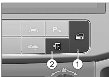
Изнутри замки дверей могут быть заблокированы нажатием на выключатель 1 для блокировки дверей пассажирского отсека и на выключатель 2 для блокировки дверей грузового отсека на панели приборов. Для разблокировки необходимо повторно нажать
