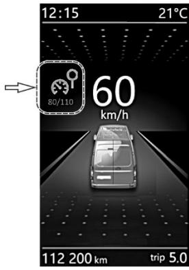
Например, после активации максимальной скорости 80/110 км/ч на главном экране появляется соответствующий сигнализатор, информирующий водителя о соотношении текущей скорости движения автомобиля с выбранной максимальной скоростью. При скорости автомобиля меньше или равной 80 км/ч сигнализатор горит в постоянном режиме (зеленый цвет). При превышении скорости автомобиля больше 80 км/ч, но
