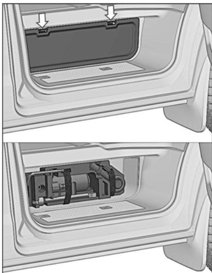
Комплект инструмента и домкрат упакованы в специальный вкладыш и размещены в отсеке подножки со стороны пассажира, закрываемом крышкой.
