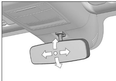
Внутреннее зеркало заднего вида регулируйте поворотом вокруг шарнира его крепления.
