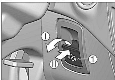
На автомобиле применяется электромеханический стояночный тормоз.
