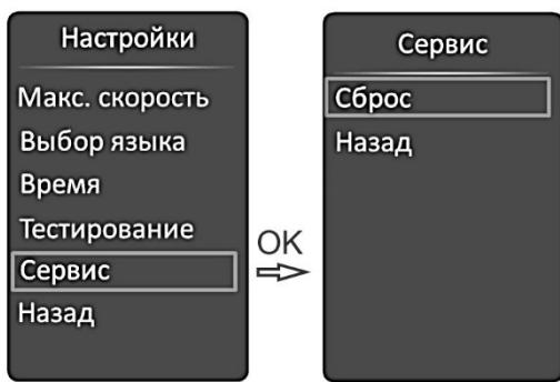
В режиме «Сервис» пользователь может выполнить сброс (возврат к заводским установкам) текущих значений пробега и моточасов до ТО.
