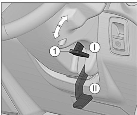
Рулевая колонка регулируется по углу наклона.
