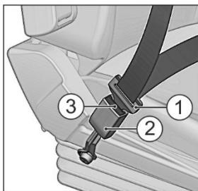
Для пристёгивания ремнём медленно (без рывков) потяните ленту ремня за язычок 1, чтобы её длина по груди и бёдрам была примерно одинаковой, и вставьте его в соответствующий данному сидению замок 2 до характерного щелчка.
