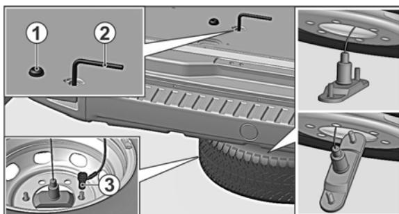
Для снятия запасного колеса извлеките заглушку 1 из панели пола или настила пола (при наличии), вставьте специальный ключ 2 в шпиндель механизма лебедки
