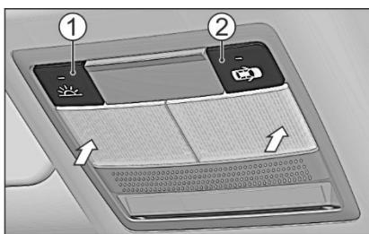
Блок освещения кабины расположен на потолочной консоли.
