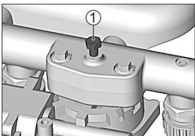
Для аварийного растормаживания автомобиля в ручном режиме необходимо закручивать специальный винт 1 на корпусе рейки электропривода стояночного тормоза, закрепленном на кронштейне, расположенном на поперечине рамы в верхней правой части шасси автомобиля.
