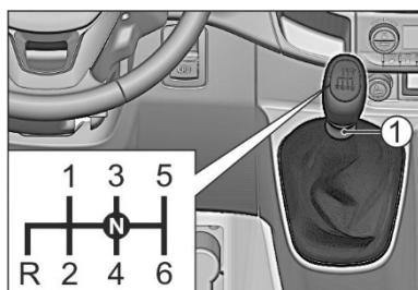
Для бесшумного переключения передач нажмите на педаль сцепления до упора. Во избежание преждевременного износа синхронизаторов, рычаг следует передвигать плавно, с кратковременной задержкой в нейтральном положении, согласно
