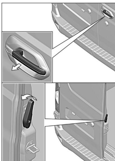
Для открывания задней правой двери снаружи/изнутри потяните на себя соответственно наружную или внутреннюю ручку правой двери. Для открывания левой двери потяните против часовой стрелки ручку на торце двери и откройте дверь. Закрывать следует сначала левую дверь, затем правую.
