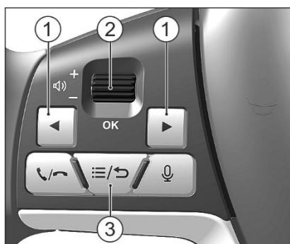
При нажатии и удержании более 0,8 сек. кнопки 3 происходит вход в режим «Меню» многофункционального дисплея. Управление мультимедийном устройством при этом возможно только кнопками на самом устройстве. Для перемещения по меню влево/вправо используются
