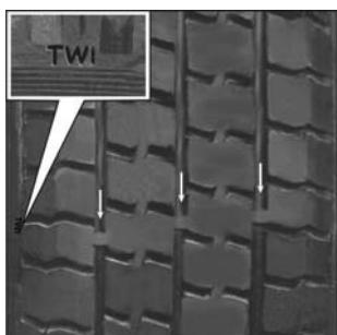
У основания протектора имеются «индикаторы износа» шин высотой 1,6 мм, расположенные поперек беговой дорожки протектора на одинаковом расстоянии по окружности. Местонахождение индикаторов износа показывает маркировка на боковине шины (например обозначение «TWI» или пиктограммы). Индикаторы износа проявляются в виде сплошных участков резины и соответствуют предельному износу шины, при глубине рисунка 1,6 мм. В этом случае шина подлежит замене.
