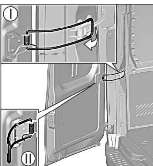
Для открытия правой или левой задней двери на 180° откройте дверь на угол меньше 90° и убедитесь, что рычаг ограничителя не находится в зацеплении со стопором (положение I), отведите рычаг ограничителя в направлении стрелки как показано на рисунке и откройте дверь. При необходимости ограничитель можно отключить (**не рекомендуется!**), зафиксировав рычаг в пружинном
