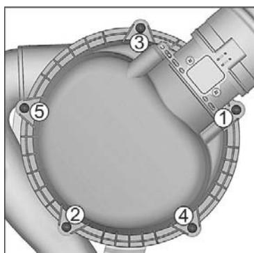
Установите крышку воздушного фильтра на корпус и затяните крепежные винты в последовательности, показанной на рисунке. Момент затяжки 2,8-3,5 Н м.
