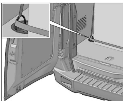
Для исключения перемещения груза на автомобилях с цельнометаллическим кузовом в грузовом отсеке предусмотрена возможность крепления груза с помощью такелажных петель.
