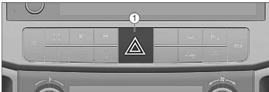
При нажатии на кнопку выключателя 1 одновременно горят в мигающем режиме все указатели поворота.
