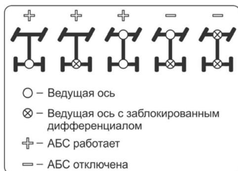
Также при включенной передней оси и блокировке заднего дифференциала отключается антиблокировочная система тормозов (зависимость работы АБС от выбранного режима трансмиссии представлена на рисунке). Поэтому перед выездом на
