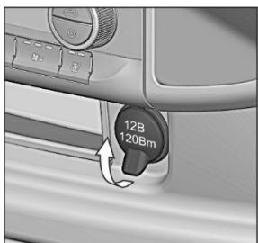
Розетка с номинальным напряжением 12В предназначена для подключения внешних потребителей (вилка переносной лампы, зарядное устройство и др.).
