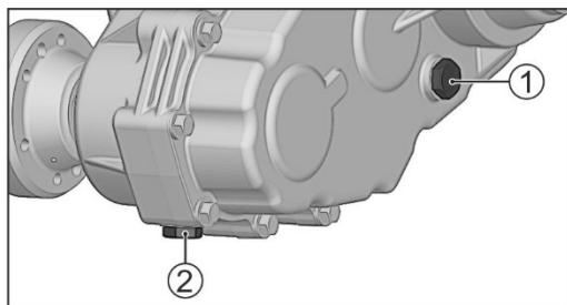
Уровень масла в раздаточной коробке должен быть по нижнюю кромку заливного отверстия, закрываемого пробкой 1.
