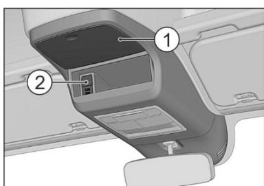
В потолочной консоли находится футляр для очков 1, а также зарядное USB-устройство 2 (5В) на два разъема. В потолочную консоль имеется возможность установить тахограф.
