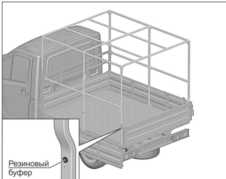
Установите резиновый буфер в задние и средние стойки каркаса.
