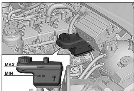
Уровень тормозной жидкости в полупрозрачном бачке главного тормозного цилиндра проверять визуально по меткам на корпусе бачка.
