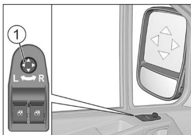
Наружные зеркала оснащены штатными боковыми указателями поворота. Для регулировки наружных зеркал с электроприводом при включенных приборах и стартере (зажигании) поворотом рукоятки 1 пульта управления выберите правое R или левое L зеркало. Перемещением рукоятки вправо или влево осуществляется регулировка по горизонтали, а вверх или вниз – регулировка по вертикали. При включенных габаритных огнях пульт управления подсвечивается.
