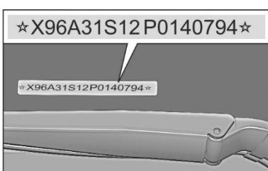
**Идентификационный номер ТС (VIN) на автомобилях и их шасси** может быть дополнительно нанесен на надставке щитка передка под стеклом с левой стороны по ходу движения.
