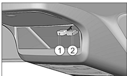
В случае отсутствия установки тахографа на предприятии-изготовителе для подключения тахографа к электрической цепи автомобиля имеются, если это предусмотрено комплектацией, два
