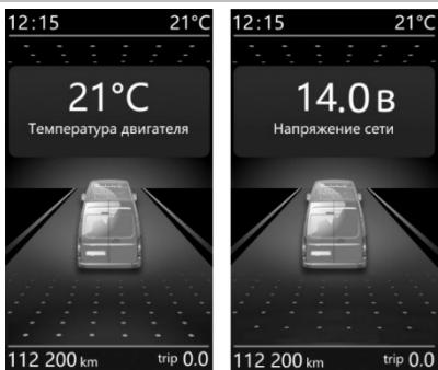
Для одновременного сброса показаний среднего расхода топлива, запаса хода, средней скорости, времени движения и пробега на маршруте необходимо нажать и удерживать более 3 секунд кнопку 3 (OK) при отображении на экране вкладки любого из сбрасываемых показаний.
