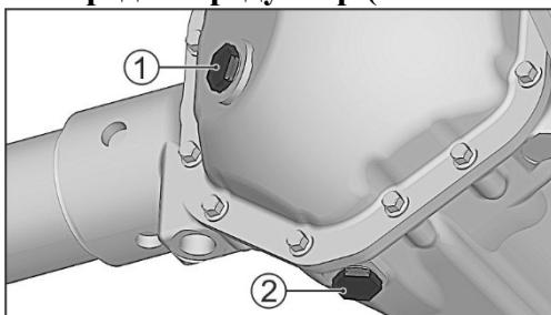
Уровень масла в переднем мосту должен быть по уровень нижней кромки заливного отверстия, закрываемого пробкой 1.
