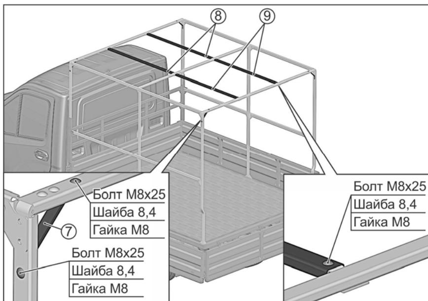
Установите раскосы 7 на передние и задние стойки каркаса тента, соединив их с дугами тента и закрепив болтами.
