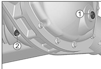
Уровень масла в заднем мосту должен быть по уровень нижней кромки заливного отверстия, закрываемого пробкой 1.
