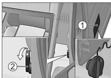
Для заправки топливом автомобиля с цельнометаллическим кузовом разблокируйте крышку люка 1 заправочной горловины, повернув ручку 2 в направлении стрелки до отпирания замка крышки. При этом под действием пружины
