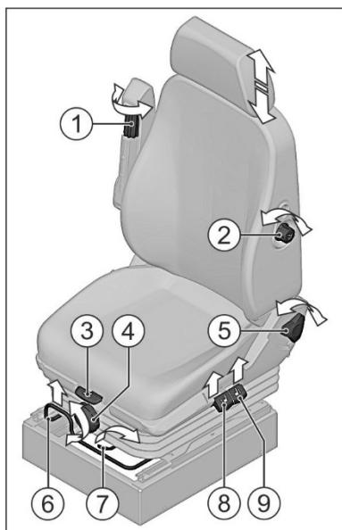
**Для регулировки подлокотника по углу наклона** поворачивайте рукоятку 1 как показано на рисунке и выберите желаемое положение подлокотника.
