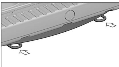
На автомобилях 4x4 в задней части рамы расположено заднее буксирное устройство. По краям устройства расположены две буксирные скобы.
