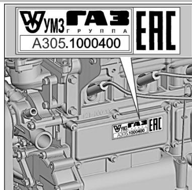
**Обозначение исполнения двигателя.** На крышке коробки толкателей расположена табличка двигателя, содержащая обозначение исполнения двигателя.
