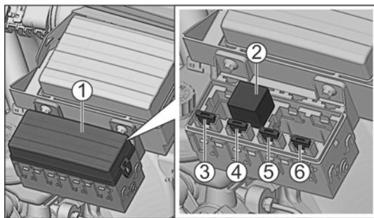
Под капотом, слева перед основным блоком реле и предохранителей на отдельном кронштейне расположен дополнительный блок реле и предохранителей. Для доступа к реле и предохранителям
