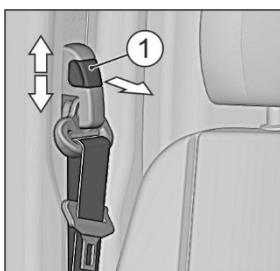
Для регулировки положения верхней направляющей потяните на себя кнопку 1 и одновременно двигайте ее либо вверх, либо вниз по необходимости.
