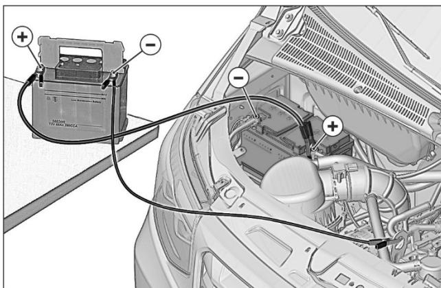
Если аккумуляторная батарея Вашего автомобиля разряжена, двигатель можно пустить от батареи другого автомобиля. При этом, обе батареи должны
