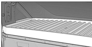
На автомобилях с цельнометаллическим кузовом и высокой крышей над водителем предусмотрена полка для багажа.
