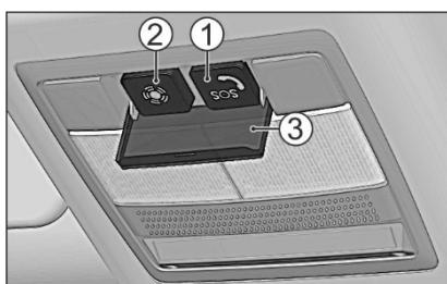
В УВЭОС входит кнопка 1 экстренного вызова «SOS», совмещенная с индикатором состояния системы, кнопка 2 дополнительных функций, расположенные в блоке освещения салона, а также блок управления, расположенный под панелью приборов. В блоке освещения салона также располагаются громкоговоритель и микрофон.
