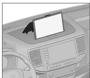
В крышке кармана для документов дополнительно предусмотрено место под установку планшета. Верхняя часть планшета крепится в специальном откидывающемся фиксаторе на открытой вверх крышке ниши, нижняя часть планшета опирается в специальный упор в нише.
