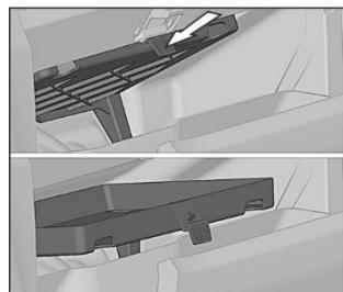
В верхней части отделения, закрываемого крышкой нижнего вещевого ящика, располагается специальный карман для хранения инструкций, прикладываемых к автомобилю. Для доступа к карману надавите на ручку кармана в направлении стрелки.
