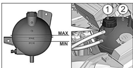
Проверку уровня охлаждающей жидкости в расширительном бачке 2 производите только на холодном двигателе.
