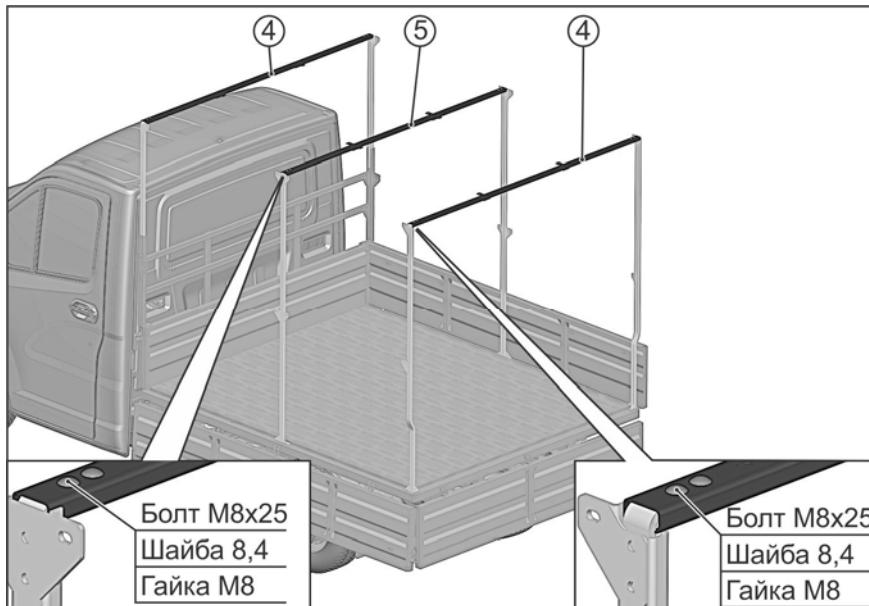
Соедините дугу тента переднюю 4 со стойками тента передними, закрепив их болтами.
