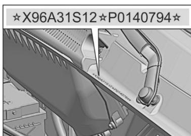
**Идентификационный номер ТС (VIN) на автомобилях и их шасси** наносится под капотом на наружной передней панели передка с правой стороны по ходу движения.
