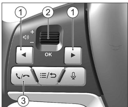
1. Кнопки выбора радиостанции в активированном диапазоне частот или выбора трека. При удержании кнопки – поиск станции или прокрутка трека.
