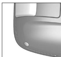
На некоторых комплектациях автомобилей установлены наружные зеркала заднего вида с вмонтированными в корпус камерами системы кругового обзора.
