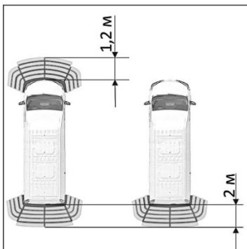
Система безопасной парковки состоит из 8 ультразвуковых датчиков, оригинальных бамперов с держателями для установки датчиков, комплекта проводов и блока управления. Опционально компонент может состоять из 4 ультразвуковых датчиков. Система обнаруживает объекты на расстоянии 2 м сзади и 1,2 м спереди ТС.
