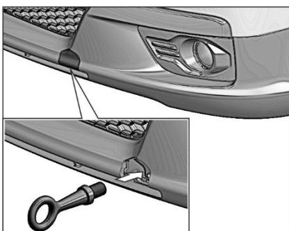
В передней части рамы к лонжеронам крепятся штампованно-сварные кронштейны. Левый кронштейн (автомобиль 4x2, 4x4) и правый кронштейн (автомобиль 4x4) имеет приварную втулку, в которую при буксировке или вытаскивании застрявшего автомобиля необходимо
