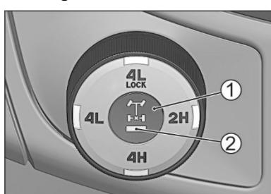
Включение и выключение блокировки дифференциала заднего моста осуществляется кнопкой 1 на переключателе режимов управления трансмиссией. При включении блокировки загорается оранжевым цветом сигнализатор 2.
