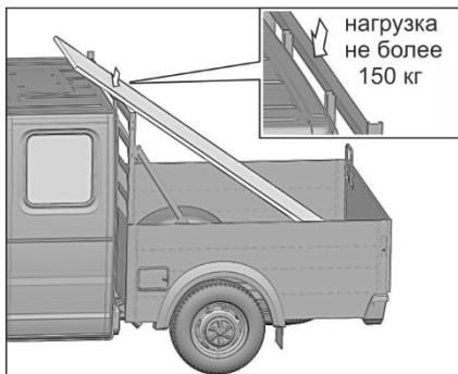
На автомобилях с платформой при перевозке длинномерного груза с частичной опорой на передний надставной борт, как показано на рисунке, нагрузка на верхнюю поперечину переднего надставного борта не должна превышать 150 кг.
