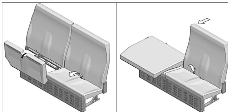
Для доступа в ящик потяните за ремешок подушки и откиньте подушку вперед до вертикального положения.
