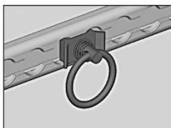
На некоторых комплектациях автомобиля на боковинах кузова грузового отсека дополнительно установлены рейки крепления груза. В рейках имеются специальные пазы для фиксации петли крепления груза. Фиксатор петли поджат к
