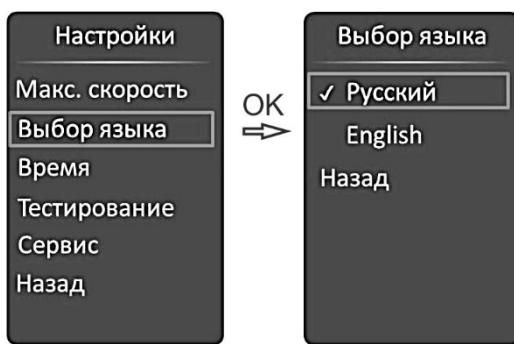
Для входа в режим «Настройки» при отображении главного экрана многофункционального дисплея нажмите кнопку 2 (MODE). Для перемещения по списку нажимайте кнопку 2 (MODE). Для открытия
