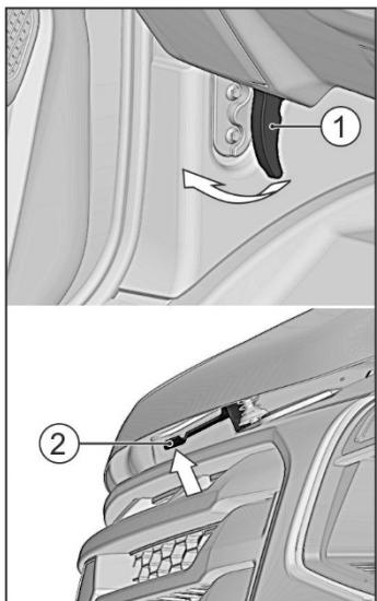
Потяните за ручку 1 замка капота, расположенную слева под панелью приборов.
