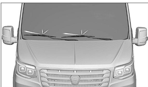
При недостаточном напоре струи воды (стеклоомывающей жидкости) в первую очередь проверьте наличие омывающей жидкости в бачке стеклоомывателя.
