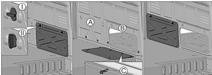
На автомобилях с цельнометаллическим кузовом и однорядной кабиной в перегородке грузового отсека имеется люк для перевозки длинномеров, закрытый крышкой.
