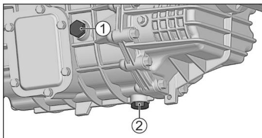
Уровень масла в коробке передач должен быть по нижнюю кромку заливного отверстия, закрываемого пробкой 1. Уровень масла проверять через отверстие,
