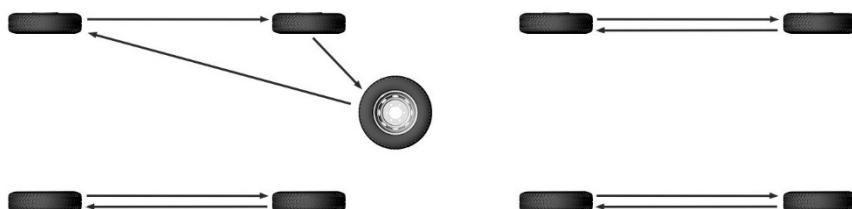
Основанием для перестановки колес могут служить необходимость получения равномерного износа всех шин, в том числе и запасной, а также обеспечение правильного подбора шин по осям. На оси следует устанавливать шины, имеющие одинаковый износ протектора, причем более надёжные шины следует устанавливать на переднюю ось автомобиля.
