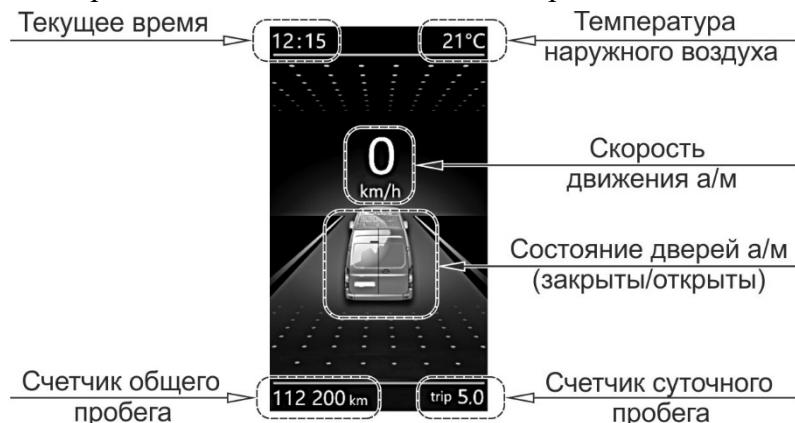
На главном экране отображается следующая информация:
